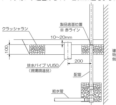
5 パンの排水口を排水パイプに合わせて設置します。
